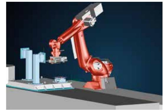
Помимо 3-5-осевого фрезерования на обрабатывающих центрах ПО Tebis великолепно подходит для NC-программирования 6-9 осевых промышленных роботов.
