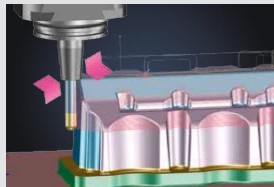
Ещё во время расчета Tebis распознаёт опасности столкновения и либо уменьшает участок обработки, исключая возможные риски столкновения, либо преобразует 3-осевые траектории в 5-осевые, автоматические отклоняя инструмент на безопасное расстояние.
