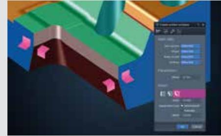
**Создание поверхностей реза с меньшим углом наклона**
