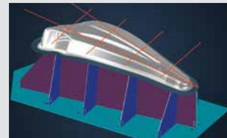
**Полное обновление функции конструирования силовой оснастки**
