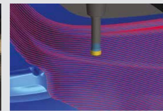
Высокое качество создаваемых в Tebis поверхностей автоматически передаётся в NC-программы. Оно обеспечивает расчёт траекторий движения инструмента всегда на математически точных CAD-поверхностях вместо заменяющих моделей типа промежуточных фасетных тел. Путём распределения точек тоже можно повлиять на конечное качество поверхности. А там, где сразу достигнуто совершенное качество поверхности, не требуется ручная доводка.
