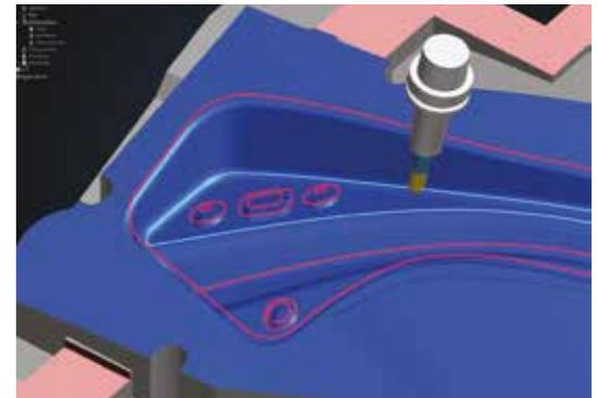
С помощью специальных CAD-функций NC-программисты готовят модели для последующих операций, учитывая требования NC-обработки. Быстрое и простое NC-программирование, уменьшение времени изготовления и высокое качество поверхностей достигается в том числе и благодаря превосходно подготовленным деталям.
